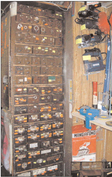
Cassettiera per chiodi e minuteria di ferramenta costruita da Tiburzio con materiali d'imballaggio recuperati
